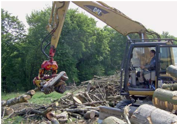
Abb. 5.16: Aufarbeitung mit dem Prozessor
