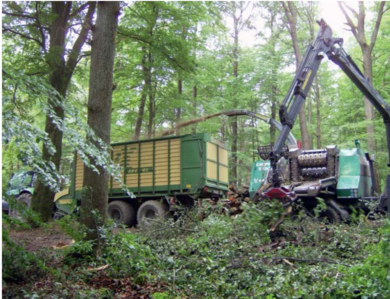
Abb. 8.3: Anhängerhacker Komtech Chippo 510C im Einsatz
