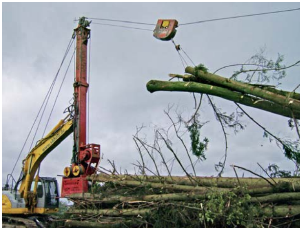
Abb. 5.14: Seilkranbagger im Einsatz
