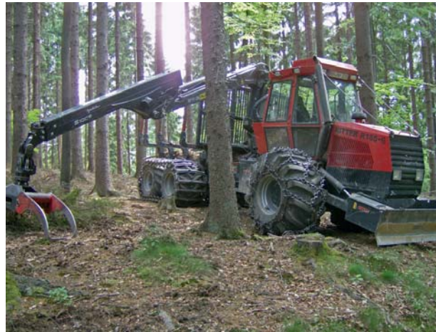
Abb. 5.19: Forwarder mit 10 m Kran
