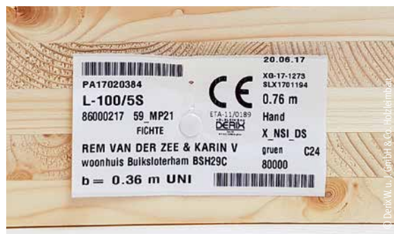
Brettspertholzelement mit CE-Kennzeichnung
