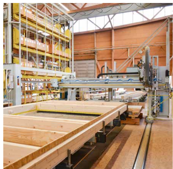
Hoher Vorfertigungsgrad im Holzrahmenbau
